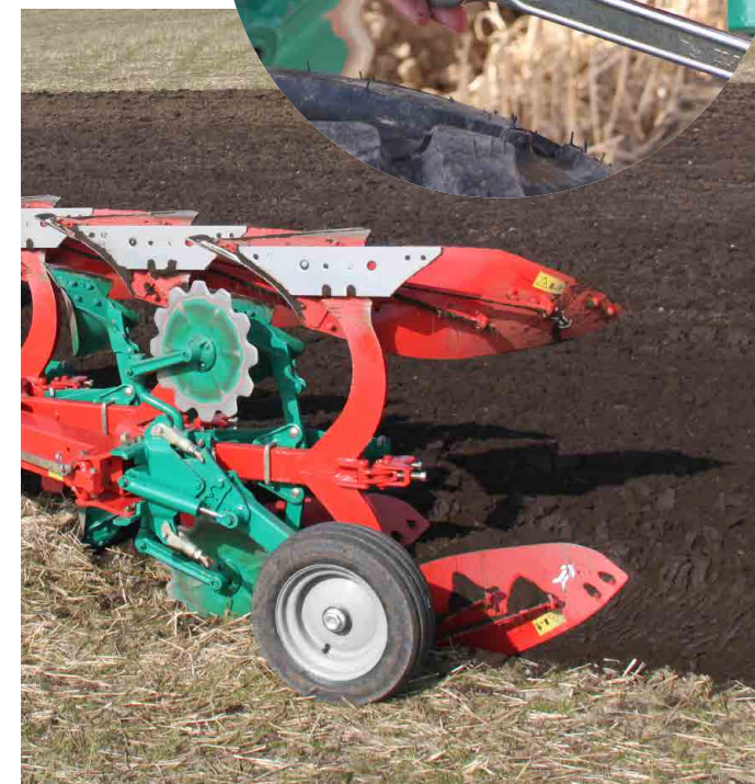
Ajuste sencillo mediante horquillas roscadas
